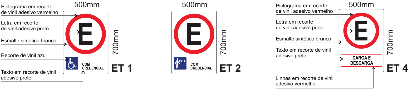
PLACAS DE ESTACIONAMENTO LAYOUT medidas em milímetros
